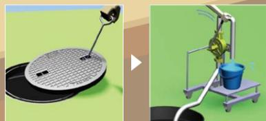
マンホールを開け、採水口に消防ポンプや手動ポンプを接続して汲み上げます。
