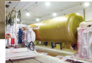
外面は腐食に強いFRP加工、内面は浸出成分が極めて少ない水道法基準適合の無溶剤形エポキシコーティングを施した、信頼性の高い鋼製です。
