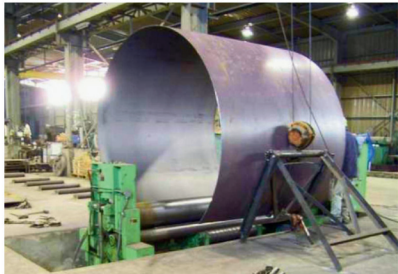
大型鋼板の曲げ・成形に対応 タンク形状や特殊形状も対応可能
