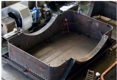
社内にて仮組み立てを実施可能 製品精度の確認・調整を事前に実施し、品質を確保
