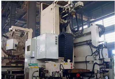
中ぐり盤：厚板・大物加工対応 大型旋盤：大径部品や円筒形状加工に強み
