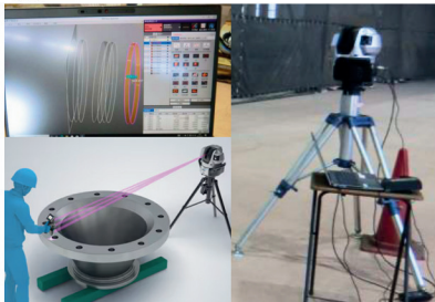
精密な検査体制を整え、高品質な製品をお届けします。キーエンスWM3500による検査の様子。
