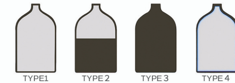
TYPE1：金属製容器 TYPE2：金属ライナー製フルラップ複合容器 TYPE3：金属ライナー製フルラップ複合容器 TYPE4：プラスチックライナー製フルラップ複合容器
